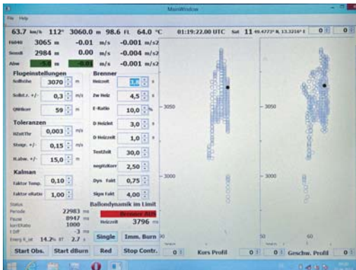
Computersteuerung nach fast 4 Stunden Fahrzeit. Höhenabweichung +5 m auf Flugfläche 99 bei 64° Hüllentemperatur
