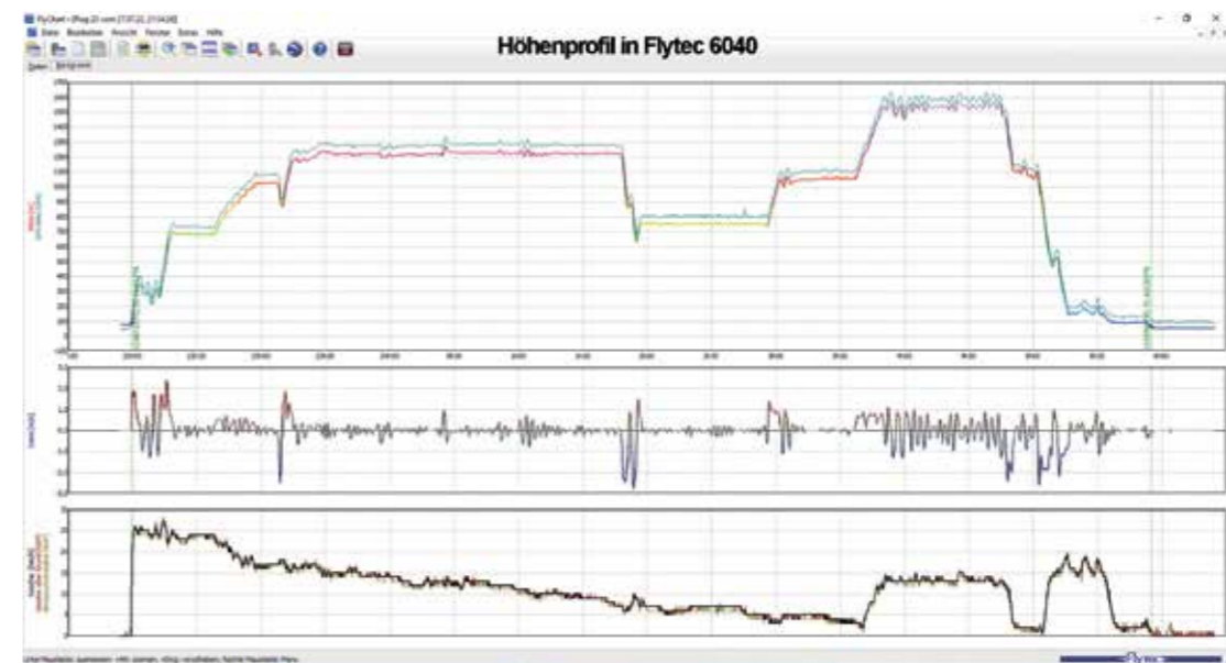
Vollständige Dokumentation des 8 stündigen Fahrtverlaufs im Flytec 6040: Man beachte die stabile, mit Hand nie erreichbare Höhengenaugigkeit von 6-8 m Standardabweichung über Stunden! Die zwischenzeitlichen Variationen resultierten vom Flaschenwechsel und den jeweiligen anschließenden händischen Brennertests. Damit lässt sich über dies die Brenndauer der einzelnen Zylinder gut zuordnen und verifizieren.
